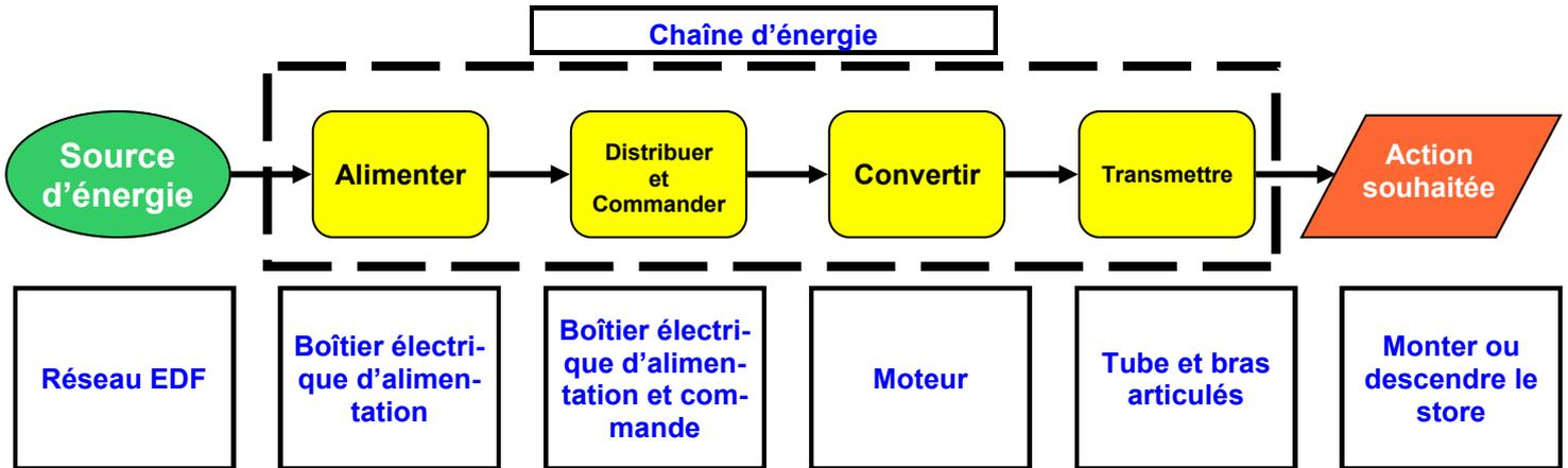
Une chaîne d'énergie comporte 4 blocs fonctionnels.
