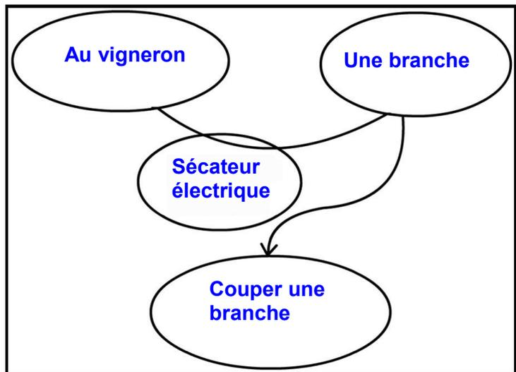
2. Le diagramme d'analyse fonctionnelle du besoin « pieuvre ».
