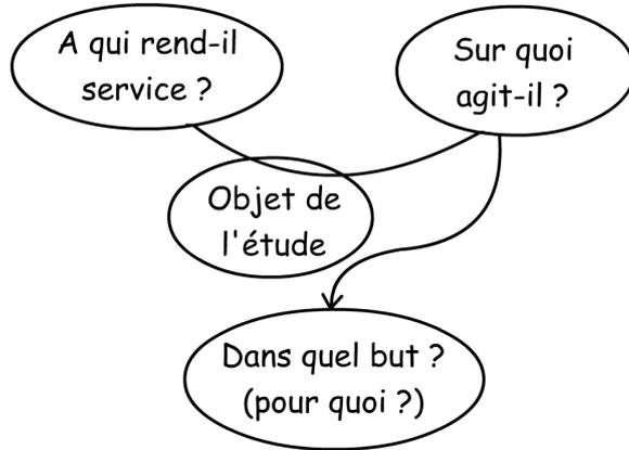
Le diagramme bête à cornes doit permettre de répondre à 3 questions
