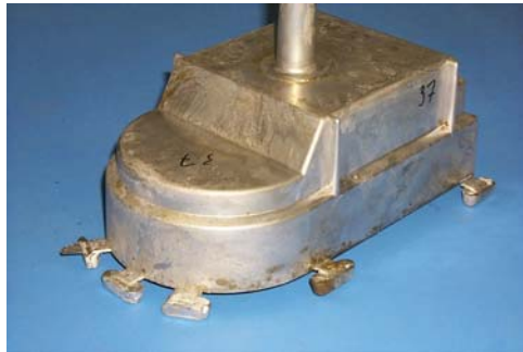
Pièce produite par moulage de métal à l'état semi-solide
